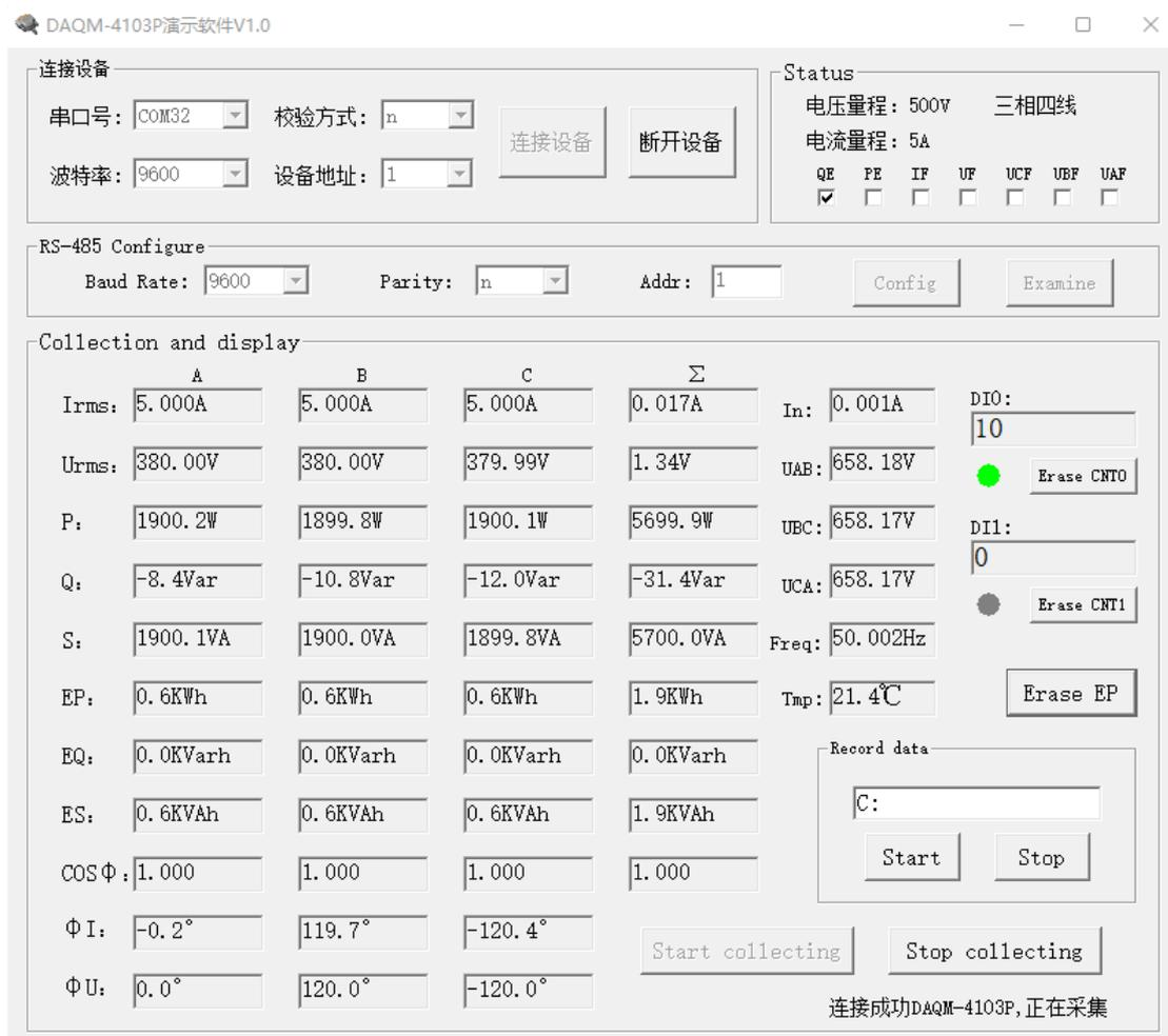
注：电压量程和电流量程和硬件有关用户不可更改，软件中显示电流量程实际为硬件电流量程 X 二次电流变比，即：40258 和 40259 寄存器值的乘积，用户可以更改二次电流变比值实现更大量电流量程。
